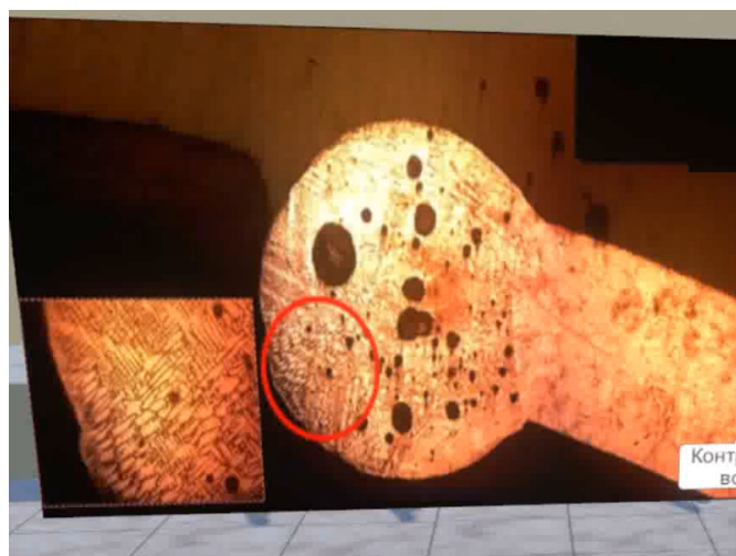
Рис. 11. Шарообразное оплавление на проводнике, обнаруженного в узле «удлинитель-разветвитель»
