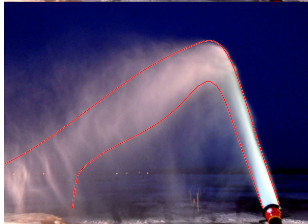
Рис. 2. Выделение границ основного потока струи огнетушащего вещества на основе распознавания
